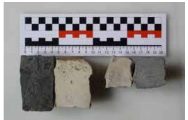
Fig. 36 - Medição e comparação de pedras usadas para calçada artística na Expo'98 (à esquerda) e na Praça do Império, 1940 (à direita). (Foto: EM)
